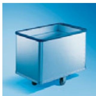
Federbodenwagen FBW • Aluminium-Wagen mit vertikal beweglichem Boden, der das Ladegut immer auf gleich bleibender Griffhöhe hält. Oberer Rand durch Leichtmetall-Profil mit Kunststoff-Polsterung verstärkt • Inhalt: 380 l • Zuladung: bis 70 kg • 2 Lenk- und 2 Bockrollen, Ø 125 mm • Lenkrollen mit Radfeststeller • H 86, B 69,5, L 111,5 cm
